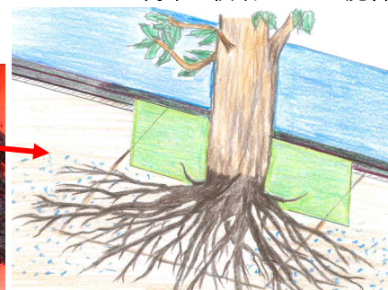
砕石にFlocksとバーク堆肥の混合品を混ぜる
